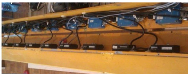
Raffigurazione della barra laser, del sensore inerziale e del computer di bordo.
